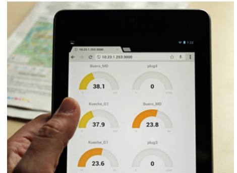
Auf einem Tablet-PC können Luftfeuchte und Temperatur in verschiedenen Räumen angezeigt werden.
