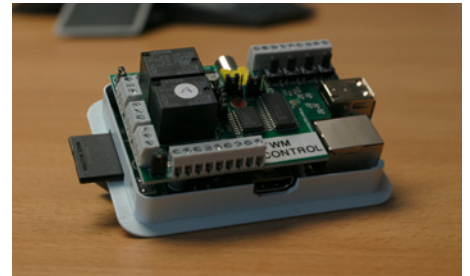
Als Zentrale für den Empfang der Raumklima-Messwerte dient ein kleiner Computer namens Raspberry Pi.
