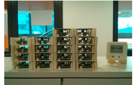
Gerade eingetroffen: Gehäuse für die EMOS-Raumsensoren - sie werden hier mit Sensor-Boards und Displays ausgestattet und zusammengebaut
